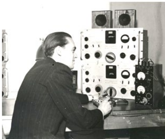
Pejl och mottagarcentral. Telegrafist med Fmr I-IV manöverenhet till höger.
