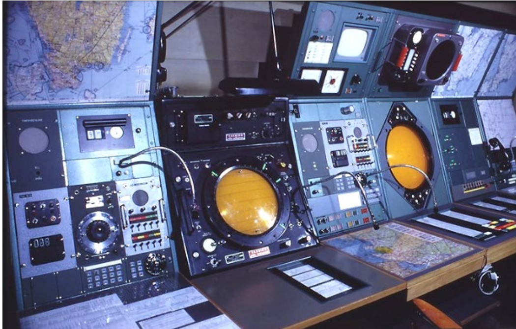
TMC med till vänster en radiostation Fmr-16, Fmr-7 manöverenhet och den 10-kanaliga expeditionspanelen.
